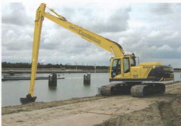
◀ Kloosterman heeft vier rupsgraafmachines met lange gieken. De langste reikt tot 22 meter en deze Hitachi ZX250 (van zo'n 33 ton) is per definitie een bagger- en dijkendamachine.
